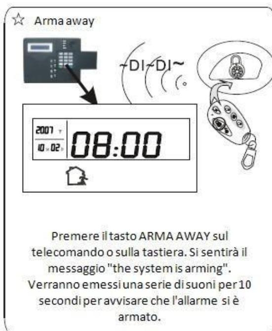
Premere il tasto ARMA AWAY sul telecomando o sulla tastiera. Si sentirà il messaggio "the system is arming". Verranno emessi una serie di suoni per 10 secondi per avvisare che l'allarme si è armato.
