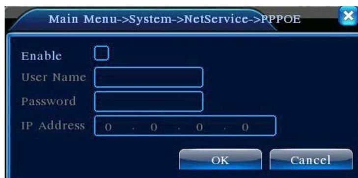
**【PPPoE setup】** Inserisci lo username e la password. Dopo di che riavvia il sistema. Il DVR ora costruisce una connessione di rete basata sul PPPoE. L'indirizzo IP cambia in IP dinamico dopo che le operazioni da eseguire sono andate a buon fine.
