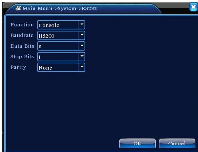
【Serial Port Function】 porta seriale che si utilizza per aggiornare e trasmettere dati.
