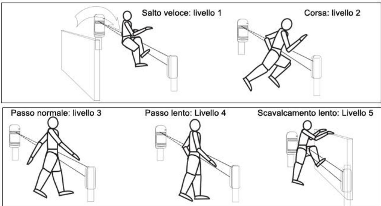
Prima di richiudere l'apparecchio, eseguire un test di passaggio per verificare l'esatta regolazione: quando il sensore va in allarme si accende il led "Alarm" rosso.
